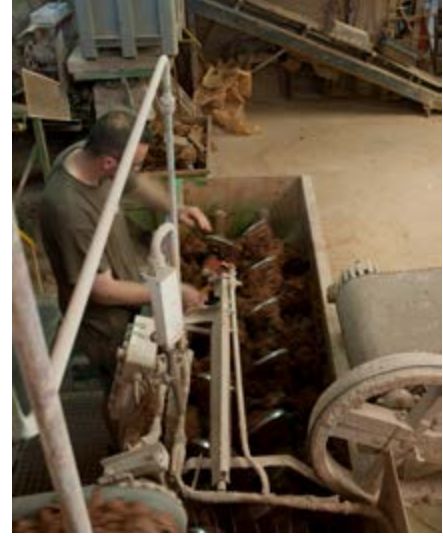
— Aujourd'hui, la machine concasse l'argile, Luc vérifie sa consistance
